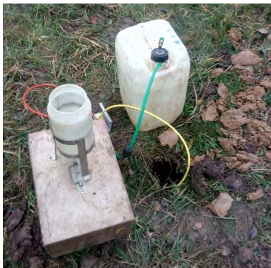
Figure 3.1 : Exemple d'essai Porchet
