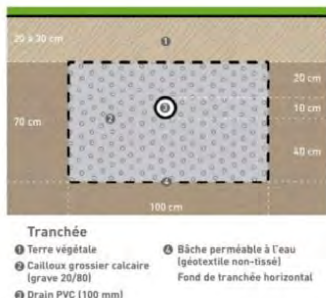
Figure 4.3 : schéma de principe
