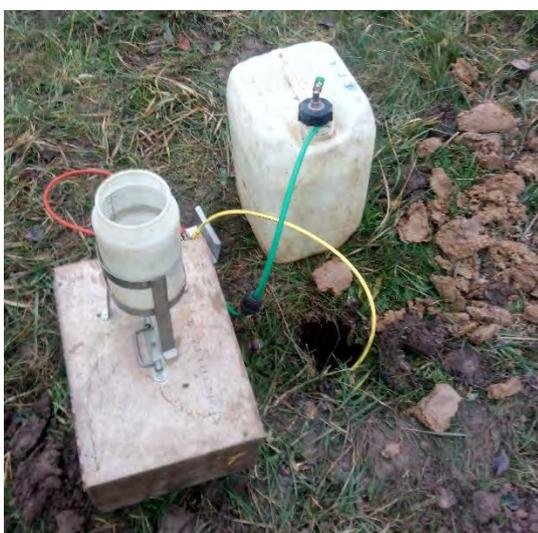
Figure 62 : Exemple d'essai Porchet
